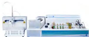
Le FLUX SOLUTION FS 3700 est un analyseur à flux continu hautement performant et évolutif. Ses détecteurs numériques (colorimétriques, ampérométriques ou par électrodes spécifiques) autorisent des analyses dans des rapports « limite de détection / point haut de la gamme » pouvant atteindre 1 / 2000 avec des cadences analytiques de 100 échantillons / heure. Ses circuits analytiques modernes sont accessibles (pièces aimantées posées sur le châssis) et sans pièces en verre.
