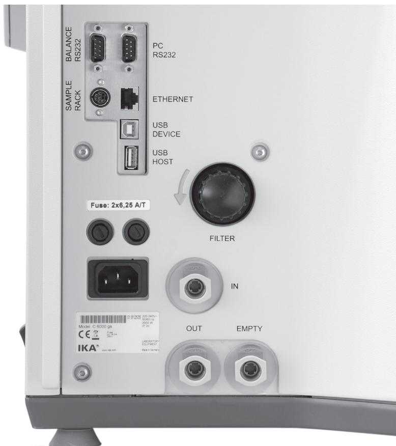
PC RS232 : Branchement en série sur la commande du calorimètre avec CALWIN ou fonctionnement avec l'imprimante série C1.50.
