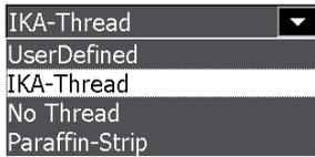
Pour « Energie externe 2 », il est possible de saisir des valeurs comprises entre 0 et 20 000 joules. Mais, des types spécifiques d'auxiliaires de combustion peuvent aussi être sélectionnés dans la liste.
