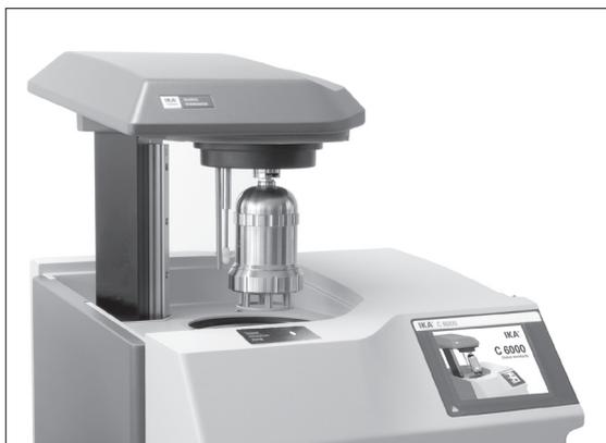
Après la mise en marche, l'écran tactile du calorimètre IKA® C 6000 global standards/isoperibol s'active et peut être commandé avec le doigt ou le stylet.
