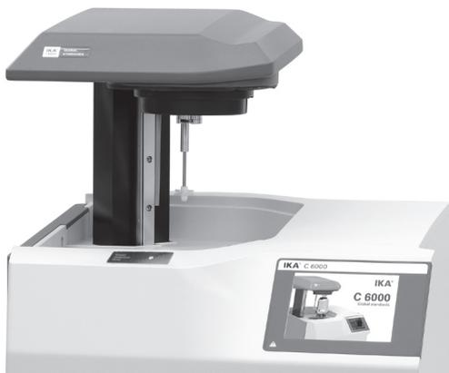
L'IKA® C 6000 global standards/isoperibol s'allume avec l'interrupteur. Le couvercle s'ouvre automatiquement. Pendant 30 secondes environ, un écran de démarrage apparaît pendant l'initialisation du matériel et le chargement du logiciel.
