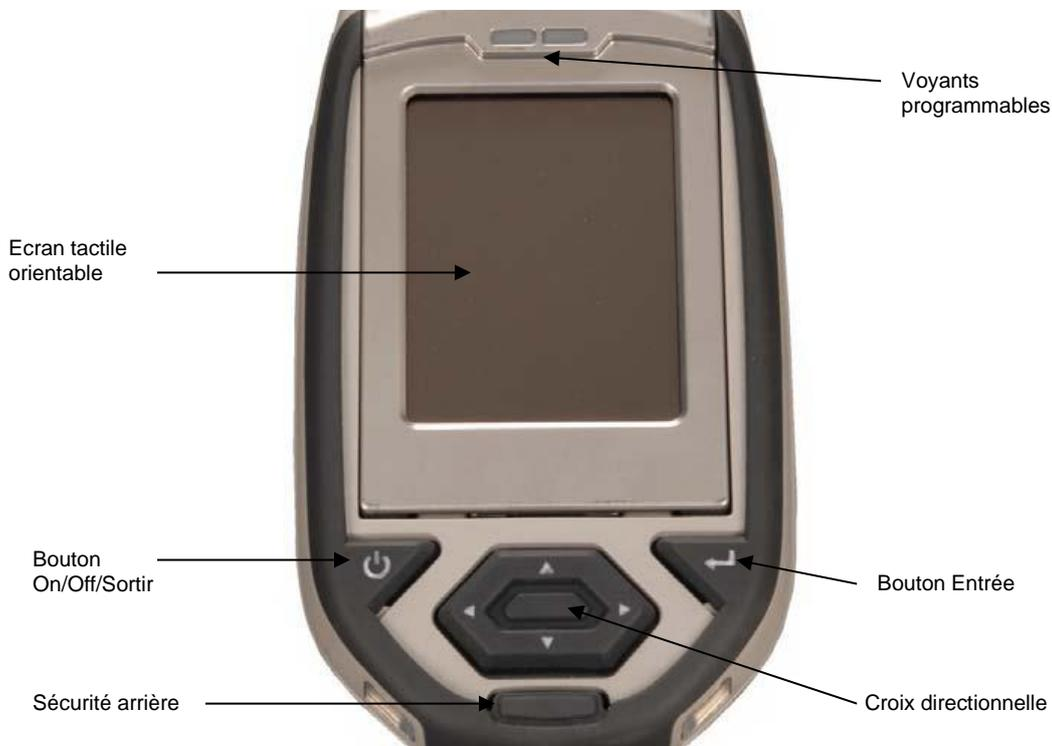
Poussez et tenez le bouton « on/off/sortir » pendant au moins 3 secondes pour mettre l'instrument en marche. Un « signal sonore » retentira.
