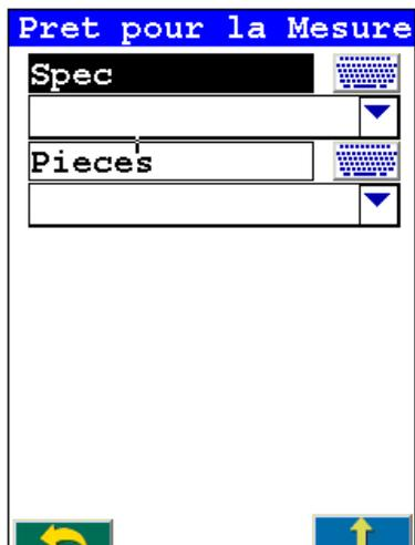
Cliquer sur l'icône « **Info Mesure** » et, renseigner les différents champs (Spec ; Pièces) par l'intermédiaire du clavier de l'écran tactile ou, en choisissant un mot dans la liste déroulante créée à partir du logiciel NDT
