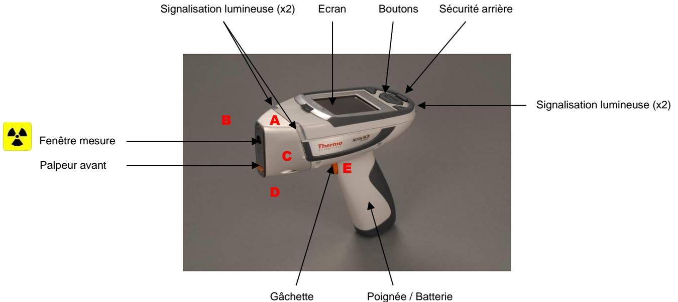
**A, B, C, D, E** : Emplacement des mesures de débit de dose équivalente dessus, côté droit, côté gauche, dessous et doigts opérateur (gâchette).
