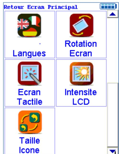
Le menu « **Système** » vous permet de régler la date et l'heure, de consulter les caractéristiques de votre NITON, d'effectuer une recherche des connexions Bluetooth avec les périphériques, de régler les données pour l'imprimante, de régler les avertisseurs audio lors des prises de mesures, de changer la langue, de tourner l'affichage sur l'écran à cristaux liquides, de régler la sensibilité de l'écran ainsi que sa luminosité et enfin de modifier la taille des icônes.
