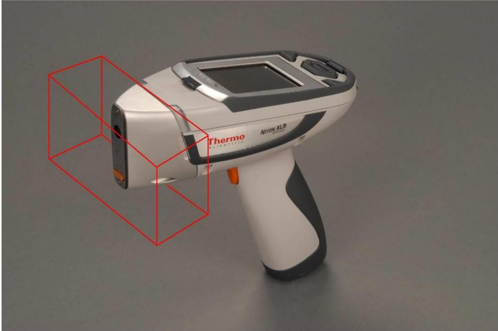
La zone surveillé correspond à la face avant de l'appareil, pendant une analyse, et 10 cm tout autour, ainsi que sur la l'échantillon lui-même et la surface analysée. L'échantillon n'est pas représenté.
