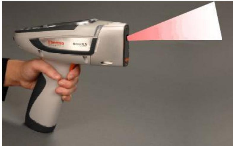
Direction et angle de sortie du faisceau
