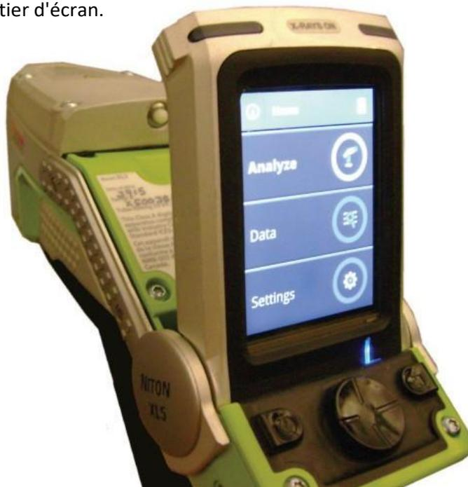
**Figure 15.** Analyseur Niton XL5 Ecran LCD incliné.
