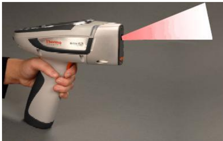
Direction et angle de sortie du faisceau
