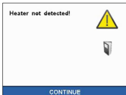
Si dans le menu de réglage l'utilisation du chauffage C 1.20 (accessoire) a été sélectionnée, mais que le chauffage n'est pas détecté, l'information utilisateur suivante s'affiche :
