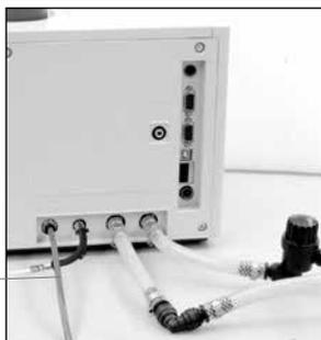
2. Bloquer l'extrémité du flexible avec une fixation collante amovible.
