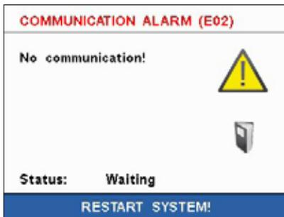
COMMUNICATION ALARM s'affiche s'il est impossible d'établir une communication interne entre le logiciel et le firmware.
