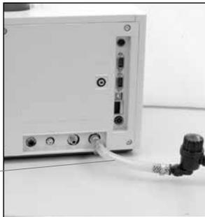
2. Raccorder le tuyau de retour avec le raccord rapide au raccord « water out » du calorimètre. Raccorder l'autre extrémité au raccord « water in » du refroidisseur et visser le collier de serrage.
