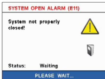
Le système n'est pas fermé correctement alors qu'une mesure est en cours.
