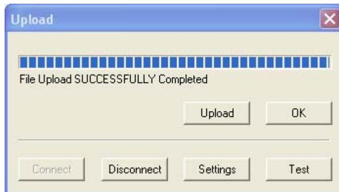
Cliquer sur OK à la fin du transfert et redémarrer l'analyseur de façon à ce que les modifications soient prises en compte. Effacer la mémoire par la méthode classique
