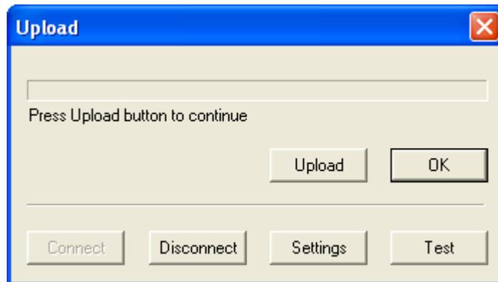
Dans « Settings », reprendre le numéro du port COM sur lequel l'appareil est connecté et laisser la vitesse à 115K. Cliquer sur le bouton « Upload ».
