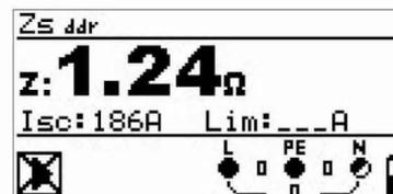
Avec la possibilité de définir des limites, le MW9660 vous permet de faire un diagnostic visuel instantané avec le système "PASS/FAIL".
