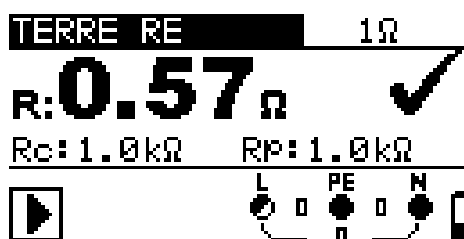
Schéma 4.32: Exemple de résultat de mesure de résistance de terre.
