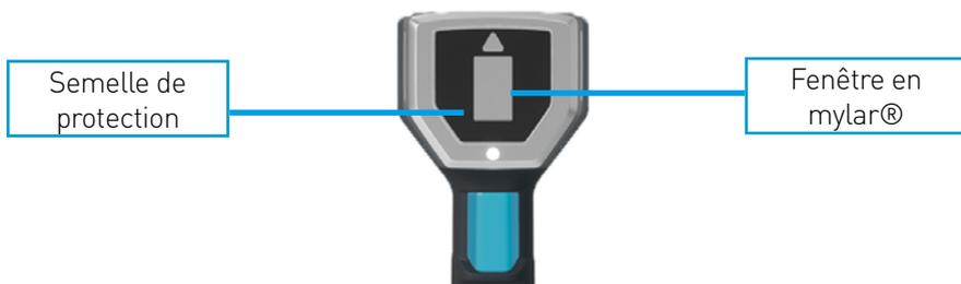
Toutes les opérations, hors nettoyage et remplacement de la fenêtre en mylar®, doivent être réalisées par les services techniques de la société Fondis Electronic.
