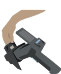
1- Insérer l'échantillon dans le compartiment
