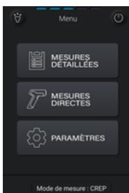
Pour éteindre l'analyseur, l'opérateur clique sur le bouton arrêt figurant sur le menu.
