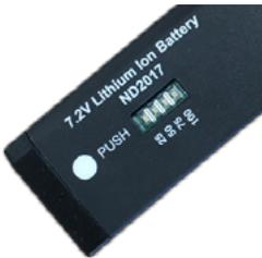
Pour connaître le niveau de chargement, appuyer sur le bouton «push», un indicateur lumineux apparaîtra.
