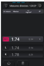
En cliquant sur la mesure, les raies L, K et l'indice de profondeur (IP) s'affichent. Le FEnX2 détermine les valeurs à indiquer.
