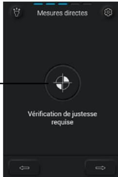
Pour lancer la vérification de justesse, l'opérateur doit cliquer sur l'icône. Un clic en dehors de l'icône ne lancera pas la vérification.
