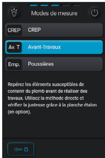
Pour vérifier la justesse, placer le museau de l'analyseur sur le standard 0.3 mg/cm<sup>2</sup> puis effectuer une mesure.
