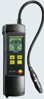
Grâce à sa pompe intégrée, à une représentation graphique de la concentration gazeuse détectée, ainsi qu'à un accumulateur intégré, le testo 316-2 est simple d'utilisation et convient parfaitement pour des mesures de contrôle rapides.
